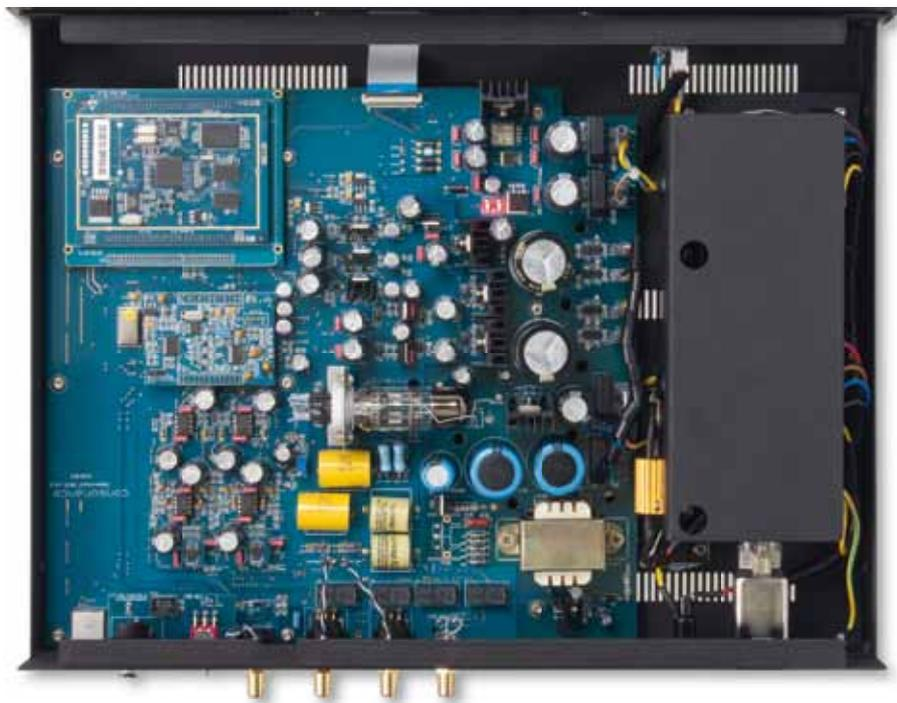
Die Analog- und Digitalteile werden von zwei Ringkerntrafos unter einem massiven Eisenblech versorgt. In der Mitte: die Doppeltriodenröhre für einen der drei analogen Stereoausgänge
